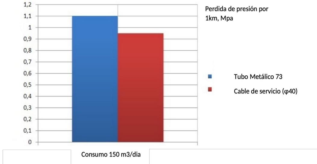
Como resultado, la resistencia del fluido hidráulico en un umbilical con un diámetro interior de 40 mm es en la práctica igual a la resistencia de la sarta de tubería NKT 73.
