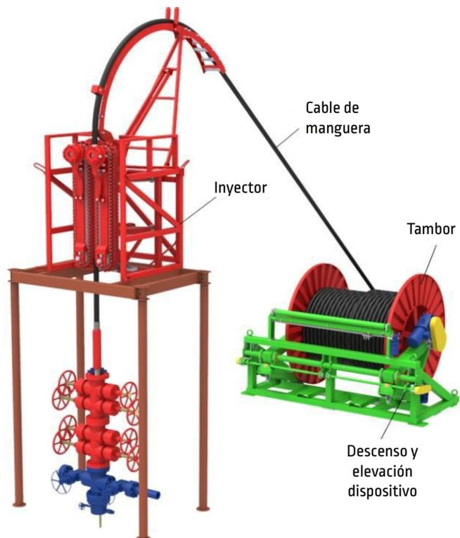
4. Con la pieza del extremo superior fuera del carrete umbilical en el gatillo y enrosque el carrete, enrosque el tubo de proceso y el umbilical en el inyector. Conecte el cable umbilical al diseño y fíjelo al elevador de 2 eslingas. ESP y un crecimiento excesivo de conductores conductivos del cable umbilical. Descender la unidad.
