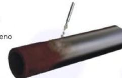
Tratamiento mecánico de la superficie sujeta a aplicación de aislamiento.
