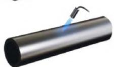
Pre caliente la superficie de la tubería sujeta a la aplicación de aislamiento
